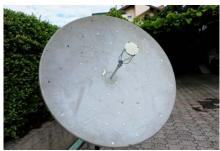
La foto a fianco mostra la parabola con incollati ben 50 specchietti convergenti su un target in cartone bianco del diametro di 11 cm. Il disco target (o bersaglio) è supportato provvisoriamente da quattro fili di ferro ancorati a un tubo plastico.
