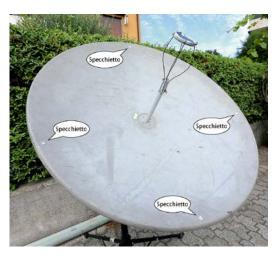
Proseguendo nelle mie prove ho provato a testare la medesima parabola con un numero minore di specchietti. Nella prova precedente ne avevo utilizzati moltissimi ma ho poi visto che anche con soli cinque specchi da 1x1 cm si poteva fare un rapido controllo.
