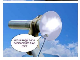
Se la parabola avesse avuto una curvatura perfetta, la macchia luminosa sarebbe stata nitida, compatta e di dimensioni contenute. Tuttavia nel mio caso, la chiazza di luce appariva invece disomogenea con vistosi sfrangiamenti laterali.
