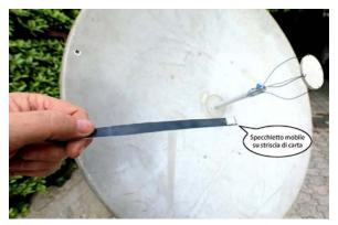
I raggi del sole riflessi dai quattro specchietti servono per trovare la migliore posizione di fuoco per il target, mentre lo specchio mobile serve per scandagliare minuziosamente ogni parte della superficie della parabola.
