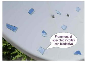
Ho poi attaccato i pezzetti di specchio alla superficie della parabola con del nastro biadesivo disponendoli nel modo più simmetrico possibile e riempiendo uniformemente la superficie del disco.
