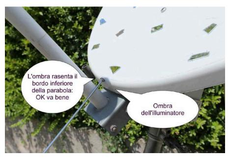
Questo test permette anche di verificare se il braccio di supporto mantiene l'illuminatore nella posizione corretta. Per fare questo controllo la parabola va puntata verso il sole in modo tale che la chiazza di luce prodotta dagli specchietti sia proiettata al centro del disco di cartone.
