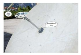
Ho puntato la parabola verso il sole facendo attenzione che l'ombra del disco target cadesse al centro della parabola. Ho poi fatto scorrere avanti indietro il disco target cercando la posizione di fuoco dove i raggi riflessi dagli specchietti convergevano su di esso il più possibile compatti.
