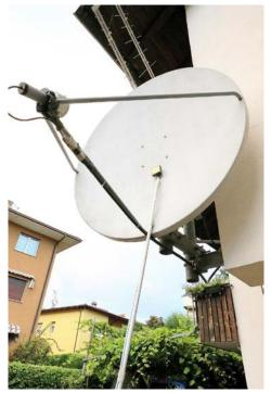
La foto alla sinistra mostra la parabola offset a 5760 durante le prime prove. Si può vedere l'antenna a spirale fissata in cima all'asta isolante usata per sondare la superficie del disco.
