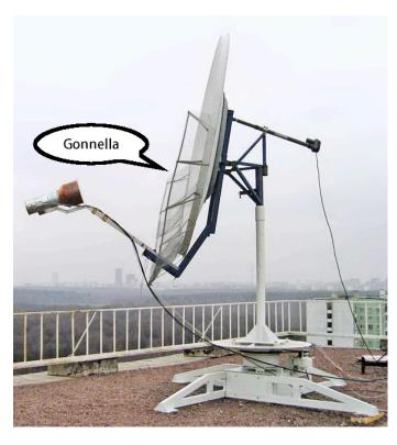
La figura a fianco illustra com'è possibile ovviare al problema dello spill-over (o debordamento) inferiore, montando una rete schermante nella parte bassa della parabola.
