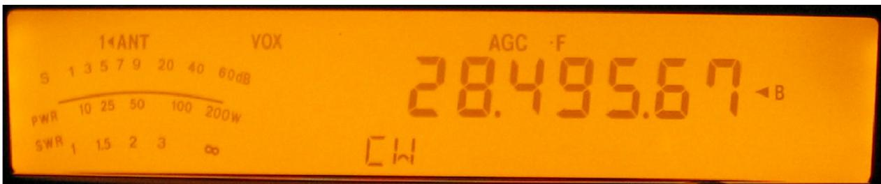
E o display indica a **frequência** (que é simultaneamente a de emissão e de recepção) e o **modo** desse VFO. (No caso destas imagens vê-se a frequência e o modo, são diferentes em ambos os VFOs.).
