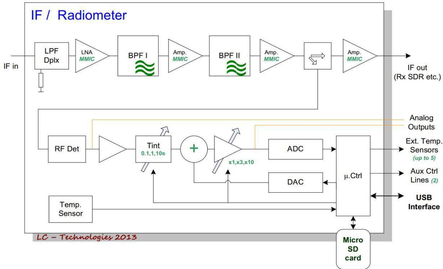
Mede a potência total na FI numa gama dinâmica superior a 60dB com uma resolução melhor que 0.001 dB. Ganho da ordem dos 45 dB. FI, 140MHz , largura de banda 6 MHz. Detalhes vê : <http://www.qsl.net/ct1dmk/rad2.html>
