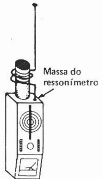
FIG. 7 — Procedimento para se medir intensidade de campo com o ressonímetro.
