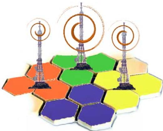
crecente de antenas de estações base, sobretudo em meio urbano, no sentido de garantir uma cobertura óptima num ambiente rico em obstáculos físicos. Tal conduz ao aparecimento de antenas nos telhados dos prédios (macrocelulares), ou instaladas na fachada de imóveis ou no interior de locais ou espaços públicos (micro ou picocelulares).
