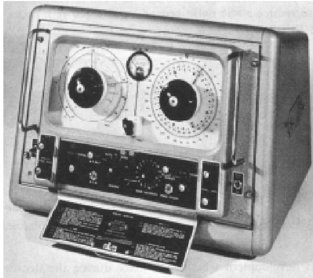
**Figura 35.13a - Radiogoniômetro Portátil com Bússola**
